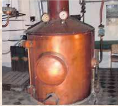
Unter sorgfältiger Kontrolle wird zweimal in kupfernen Brenngeräten gebrannt. Die Aromen gelangen so bis in den Feinbrand, da die Brenngeräte und Leitungen alle aus Kupfer hergestellt sind.
