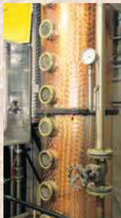
Unter sorgfältiger Kontrolle wird zweimal in kupfernen Brenngeräten gebrannt. Die Aromen gelangen so bis in den Feinbrand, da die Brenngeräte und Leitungen alle aus Kupfer hergestellt sind.
